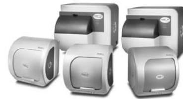
La mise en œuvre rapide et simple des systèmes Octet® est due au concept « dip and read™ » des biocapteurs s'affranchissant ainsi d'une microfluidique complexe. Par exemple, les « biosensors » Protéine A ont simplifié énormément le dosage d'Anticorps dans des lignées cellulaires, avec des débits d'analyse de 30 minutes par plaque de 96 ou 384 puits, remplaçant ainsi des tests ELISA ou HPLC plus longs et fastidieux.
